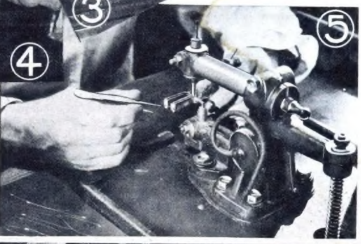
MITTELS ELEKTRISCHER PUNKTSCHWEISSUNG WERDEN DIE BLECHE AUF DEN ELEKTRODENSTUTZEN BEFESTIGT.
